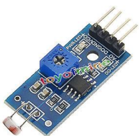
Capteur de lumière ( photorésistance ) avec sortie analogique ( A0 )
