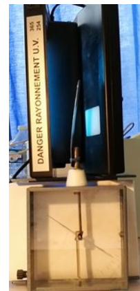
Photo 1 : Montage illustrant l'effet photoélectrique
